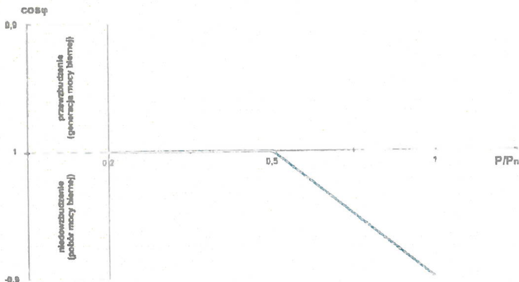
Rys.5. Charakterystyka sterowania współczynnikiem mocy \cos \varphi w funkcji generowanej mocy czynnej wymagana przez OSDn.
